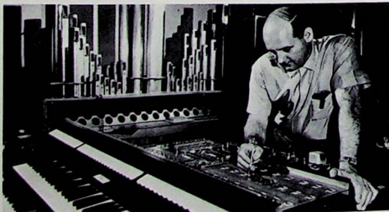
Überprüfung des Musik-Digitalrechners einer elektronischen Orgel der Allen Organ Company
